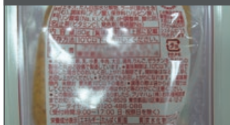
赤外光透過照明による袋内の製品形状確認
