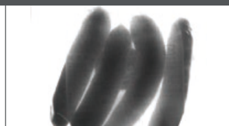
赤外光透過照明による袋内の製品形状確認
