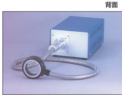
●集光位置ライトガイドアダプタより20mm奥 アダプタ内径15φ 集光点約10φ
